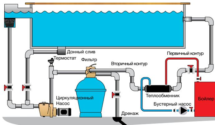
Типовая схема подключения горизонтального теплообменника.
