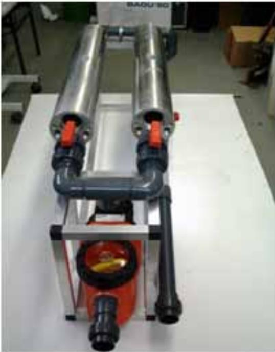
Установки UV-OXS осуществляют комбинированную обработку воды озоном и ультрафиолетовым излучением, наиболее эффективно уничтожая нежелательные соединения, в том числе и хлорамины. Установка выполнена в едином корпусе и может быть установлена как в новые, так и в реконструирующиеся бассейны.
